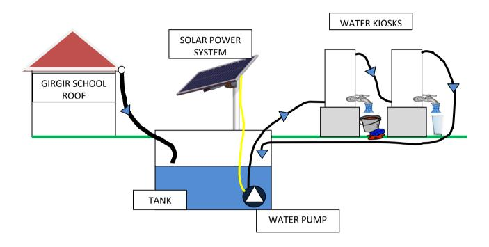
L'acqua viene raccolta dalle grondaie, convogliata dentro ad un serbatoio sotterraneo; per evitarne il deterioramento, viene fatta circolare attraversi dei piccoli serbatoi tramite una pompa alimentata da energia solare. Ogni serbatoio è dotato di rubinetto dove attingere acqua.
